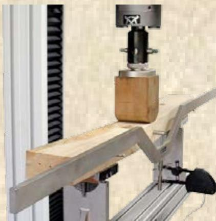
**Prueba de compresión:** Consiste en aplicar carga a un prisma de madera hasta que falle y es una prueba que reproduce el comportamiento de una columna
